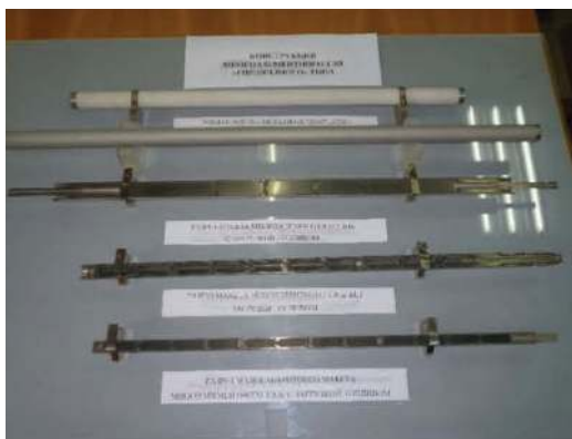
მრავალელემენტიანი თეგის „გირლანდული“ ტიპის კონსტრუქცია
