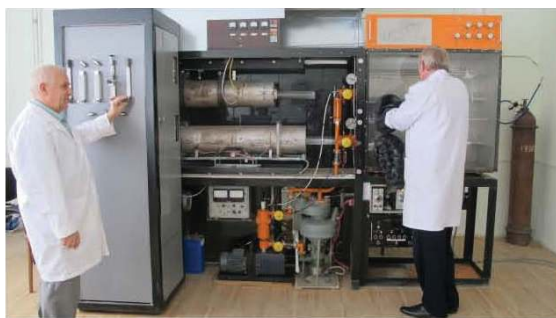
გაზოფაზური დაფენის დანადგარი (ვ. გორბაჩოვი და ფ. დანელია) Gas phase deposition unit (From the left: V. Gorbachov, F. Danelia)
