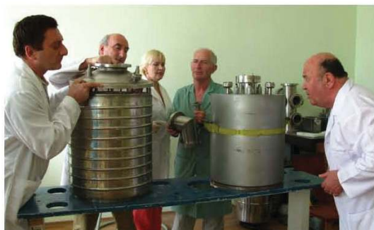
კრიოტუმბოს აწყობის პროცესი და სფტი-ში დამზადებული კრიოსტატი (მარცხნიდან: ი. მეცხვარიშვილი, ბ. ბენდელიანი, ნ. მუმლაძე, ვ. ჭანტურიძე, გ. დგებუაძე)
