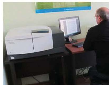
ფოტოგარდამქმნელების ოპტიკური პარამეტრების კვლევის უბანი: MDP-23 (ი.ყურაშვილი) და ფურიე-სპექტრომეტრ Cary 600, აშშ (კ.კომახიძე)
