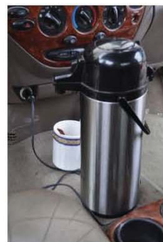
დაბალტემპერატურულ თერმოელექტრულ მასალებზე (Bi-Te- Se-n და Bi-Te-Sb-p) შექმნილი "ტურისტის ქვაბი" (4-12 ვტ) და თერმოსი
