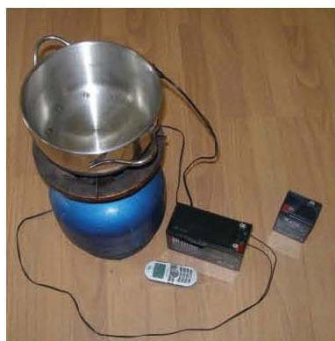
დაბალტემპერატურულ თერმოელექტრულ მასალებზე (Bi-Te- Se-n და Bi-Te-Sb-p) შექმნილი "ტურისტის ქვაბი" (4-12 ვტ) და თერმოსი
