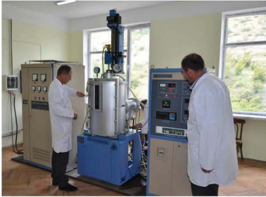
ჩოხრალსკის სადნობი ღუმელი -SKJ-50CZ (აშშ) და მასზე მიღებული ნიმუში (მარცხნიდან: ლ. ბოკუჩავა და გ. ჩუბინიძე) Czochralski melting furnace EQ-SKJ-50CZ (USA) (From the left: L. Bokuchava and G. Chubinidze) and the specimen produced on it
