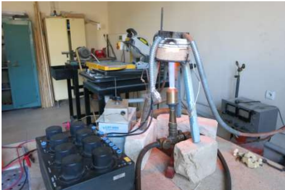
სურ. 3. თერმოელექტრული ბატარეის გამოცდა გაზისა და ჟანგბადის ნარევის გამახურებლით.
